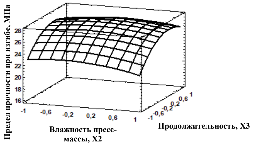
Рисунок 5.7 – Графическая интерпретация уравнения регрессии при исследовании предела прочности при изгибе
