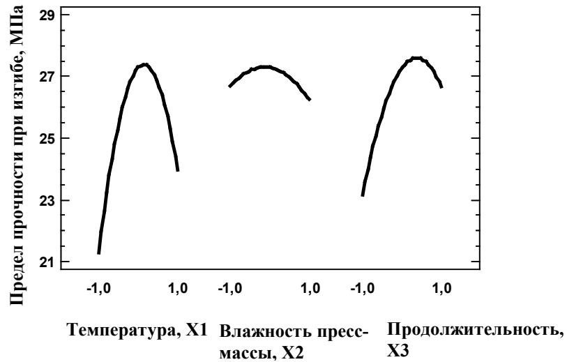
Рисунок 5.5 – График эффектов факторов при исследовании предела прочности при изгибе
