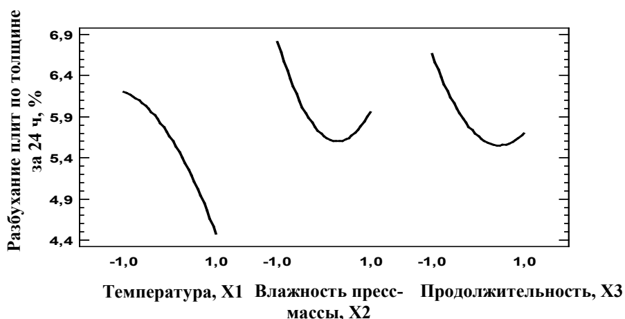
Рисунок 5.13 – График эффектов факторов при исследовании разбухания плит по толщине
