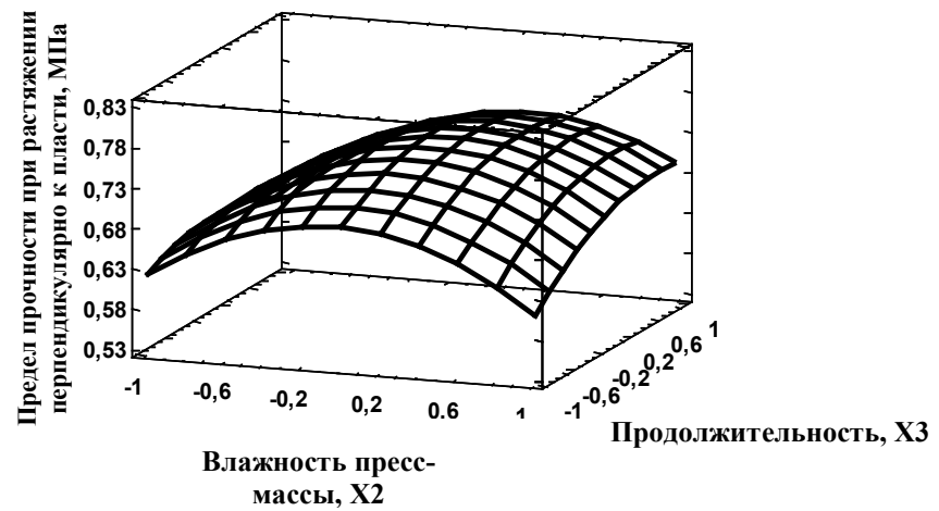
Рисунок 5.11 – Графическая интерпретация уравнения регрессии при исследовании предела прочности при растяжении перпендикулярно к пластине
