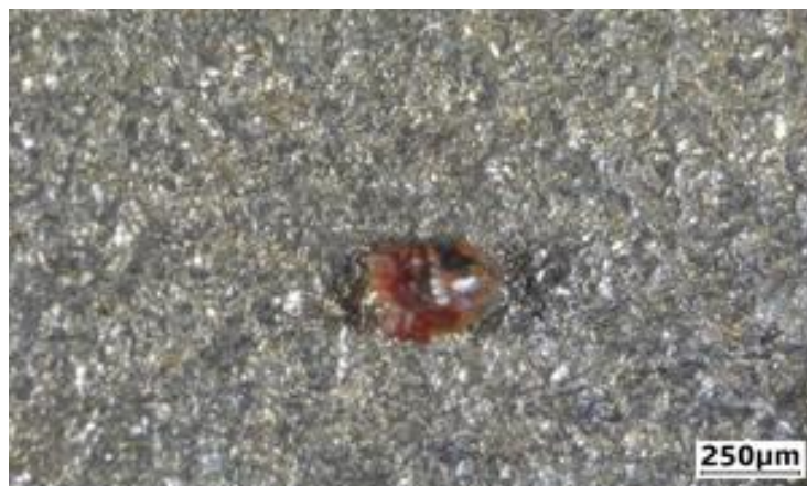
Рисунок 3.19 - Единичное зерно электрокорунда белого 25А F70 на поверхностной литьевой корке вогнутого образца
