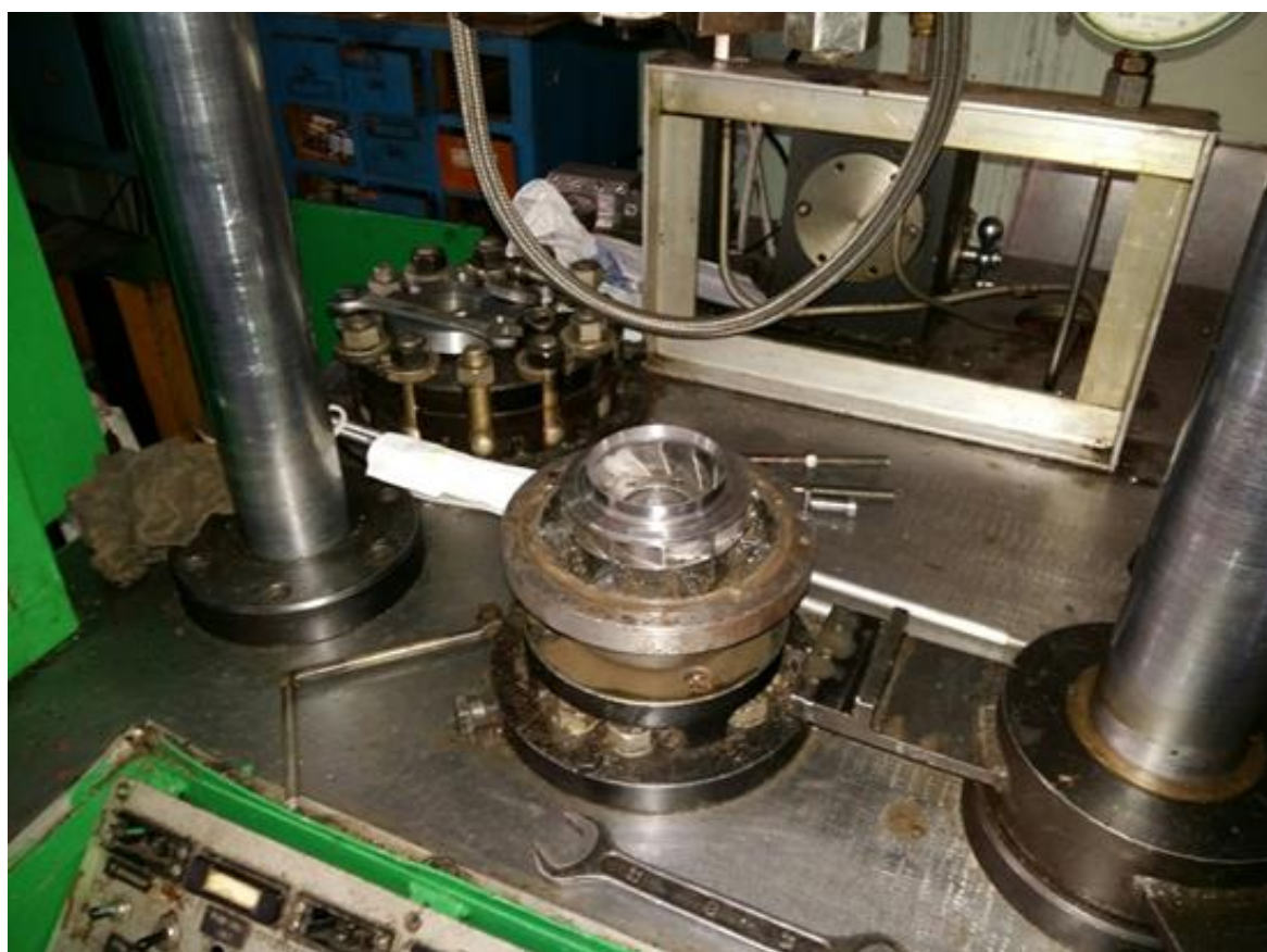
Рисунок 4.1 - Обработка абразивным потоком крыльчатки на опытно-промышленной установке УЭШ-100
