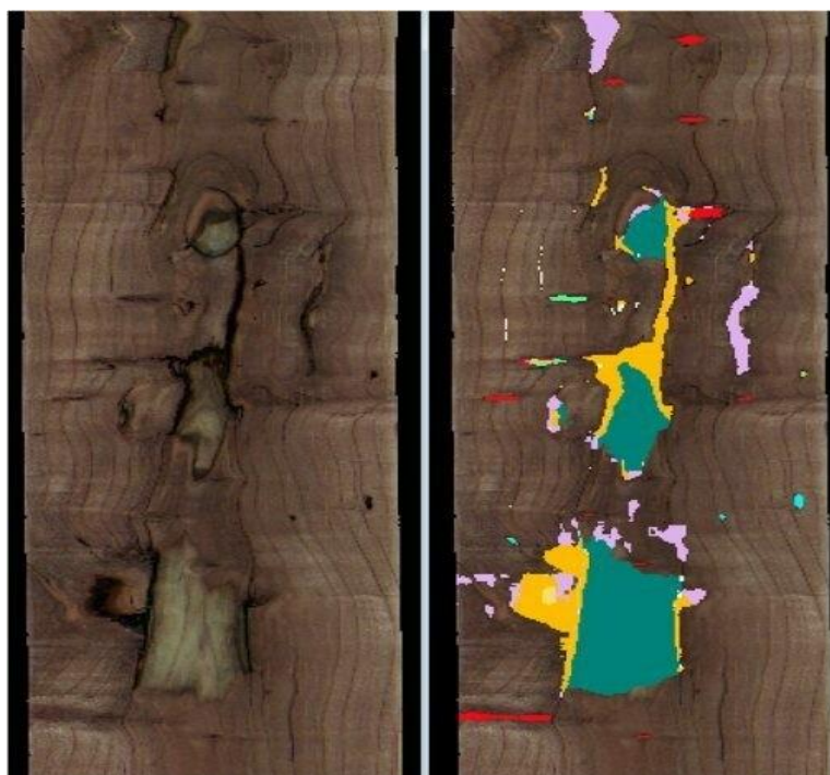
Рис. 2 – Обнаружение дефектов при помощи машинного обучения
